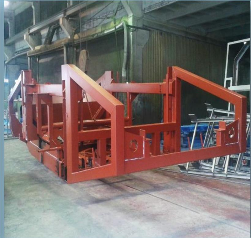
**Mobile Rahmen zum Separationssystem (Sortiermaschine)**
