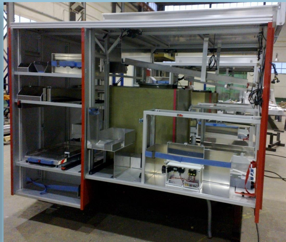
Aluminiowa zabudowa do wozów strażackich – obudowa i wnętrze
