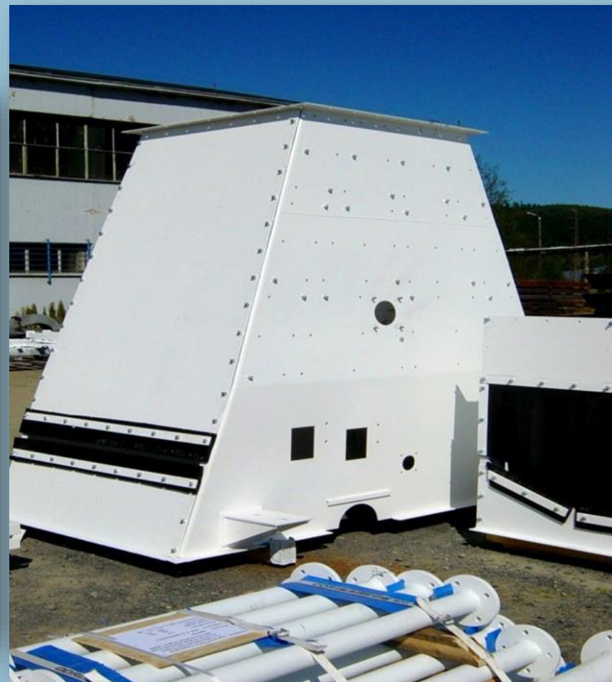
Elementy zsypu (stacji napędowej)
