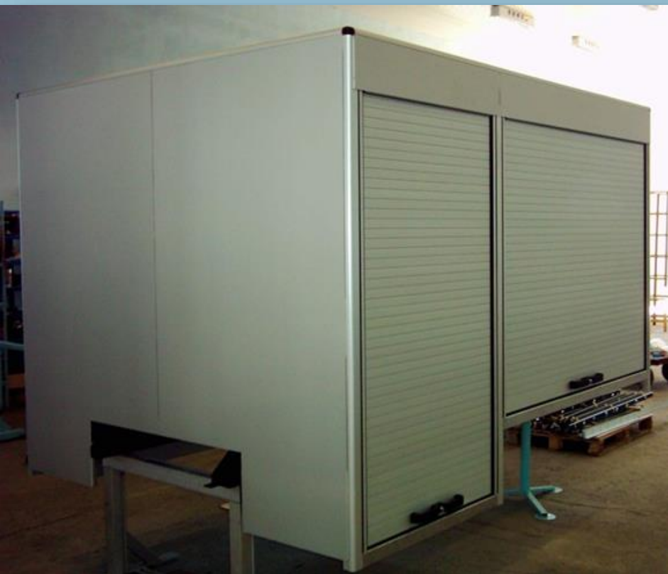
Aluminiowa zabudowa do wozów strażackich – obudowa i wnętrze
